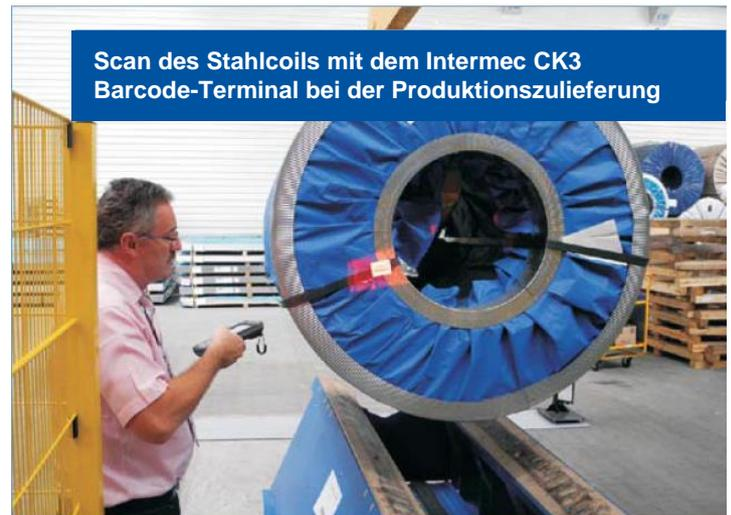
Sämtliche eintreffenden Stahlcoils müssen eindeutig identifiziert werden. Die Schmelze (Chargennummer), die Bandnummer und das Gewicht liefern eine eindeutige Kennzeichnung jedes Coils. Diese Daten befinden sich in der Regel bereits auf den Stahlcoils. Trotzdem werden sämtliche Coils am Wareneingang mit einem ABC-Etikett versehen, um den nachfolgenden Arbeitsfluss besser steuern zu können und um die Chargenverfolgung sicherzustellen.
